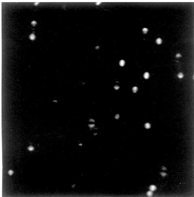
Abb. 2. Nahfeldmikroskopische Abbildung der Fluoreszenz individueller Cyaninmoleküle auf der Oberfläche eines PMMA-Films (aus Lit. [3]).
